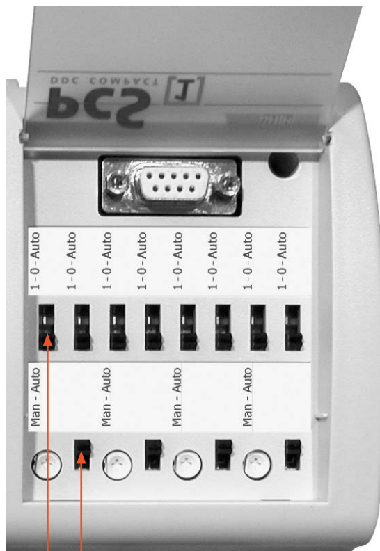
Переключатель в пол. 1 (вход I32) (управляет выходом O80 канал 1) Переключатель в пол. 1 (вход I24) (управляет релейным выходом O16)
