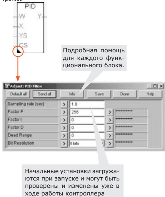
Окно настройки служит не только для установки параметров функциональных блоков, но оно позволяет также наблюдать изменение каждого параметра в процессе работы. Если это необходимо, параметры могут быть изменены без остановки контроллера. Например, можно видеть параметры работы контроллера и оптимизировать коэффициенты ПИД регулятора.
